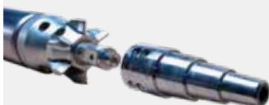
Zum Austreiben alter Stahlleitungen und gleichzeitigem Einzug von Neurohren.
