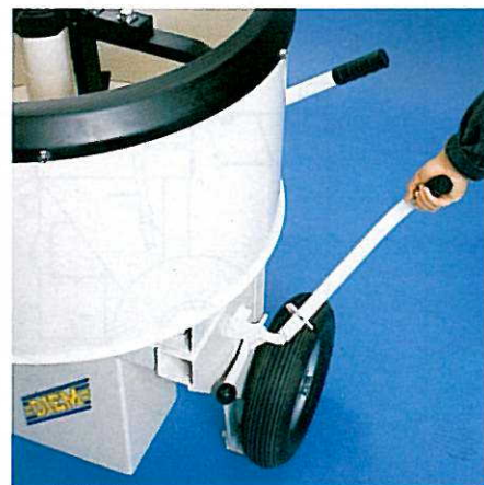
Mit Kniehebel in Arbeitsposition Tow handle detached and lifting machine
