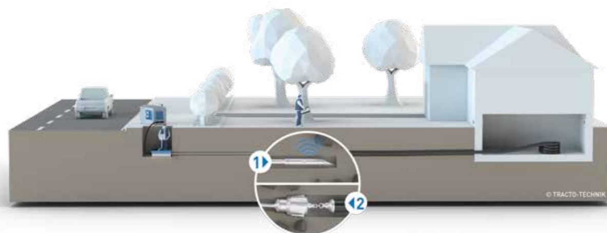
HAUSANSCHLUSS: GRUBE – KELLER
