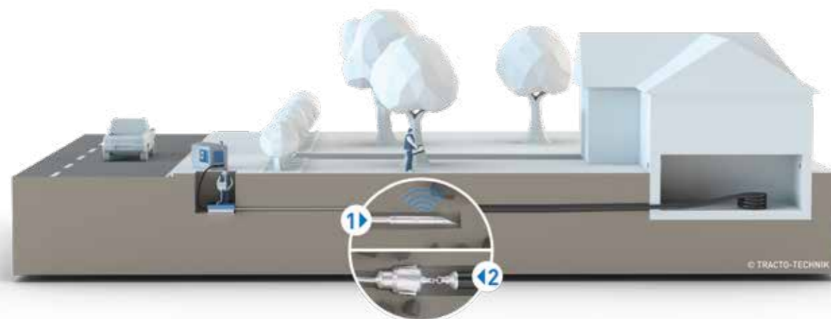
HAUSANSCHLUSS: GRUBE - KELLER
